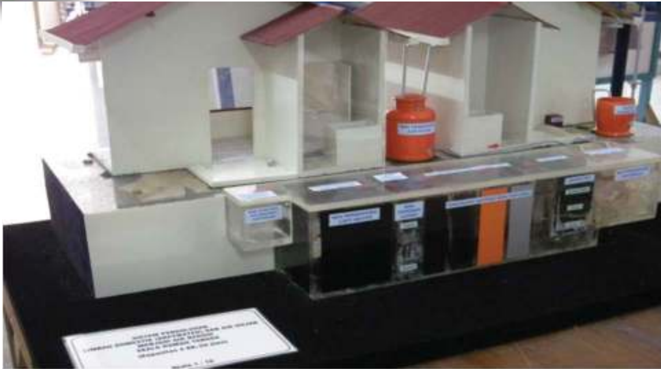
Gambar 3. Model Replika PANDORA-L dan proses pembangunannya di lapangan
